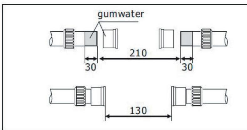
5. Installation des Wassererhitzers: (Abb. 5). Befestigen Sie den Schlauch an der Schlauchkupplung des Wassererhitzers. Bitte achten Sie darauf, dass die Verbindung ganz dicht ist. Bitte beachten Sie auch, dass die Komponenten aus Kunststoff bestehen und daher kaputt gehen können, wenn die Überwurfmutter zu fest angezogen wird.
