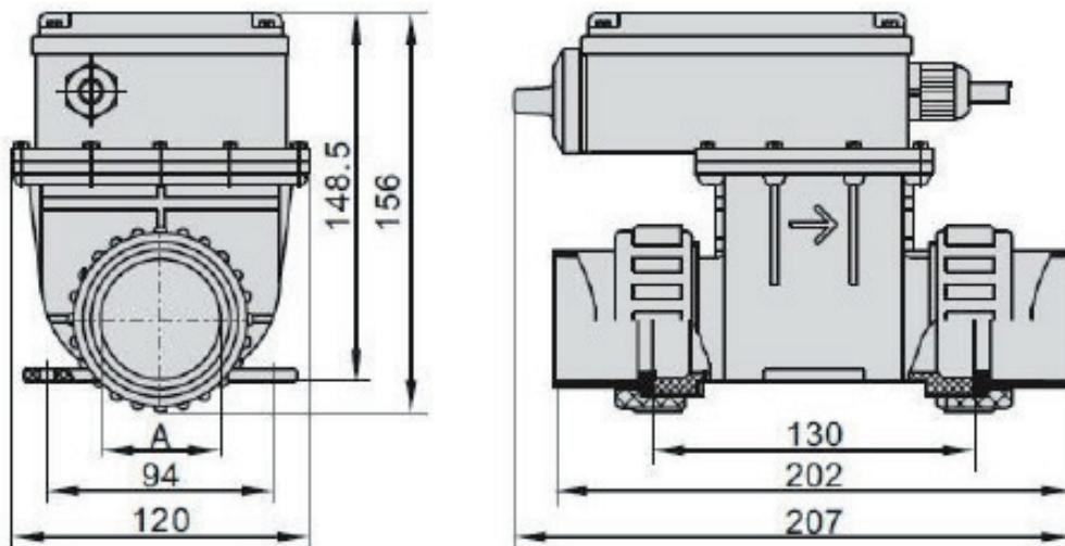
2. Der Wassererhitzer kann am Pumpenzulauf oder -ablauf (Abb. 2) angeschlossen werden.
