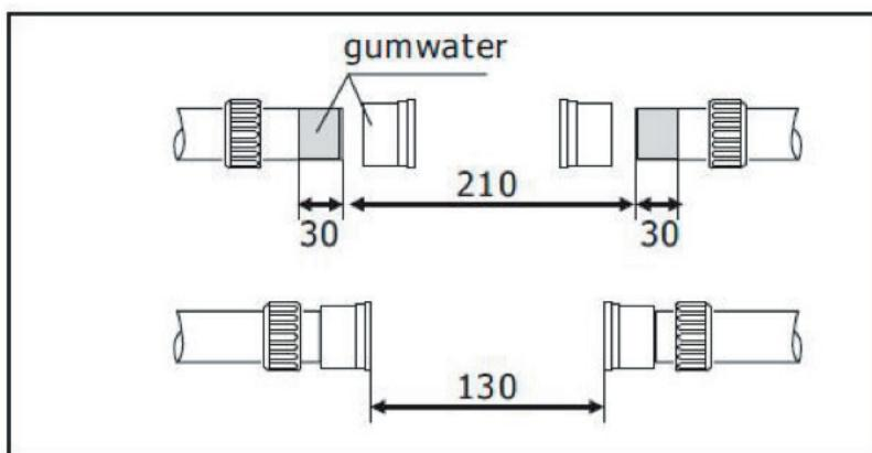
5. Installera värmaren (fig. 5) Montera slangen på värmarens slangkoppling. Se till att alla sammankopplingarna är helt tätta. Spänn inte för hårt eftersom plastdelar lätt kan gå sönder.
