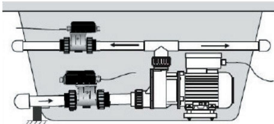
**HINWEIS:** Das Anschlussrohr bzw. der Anschlussschlauch muss den gleichen Durchmesser haben wie der Rest des Rohrsystems im Spa/Wildmarksbad.
