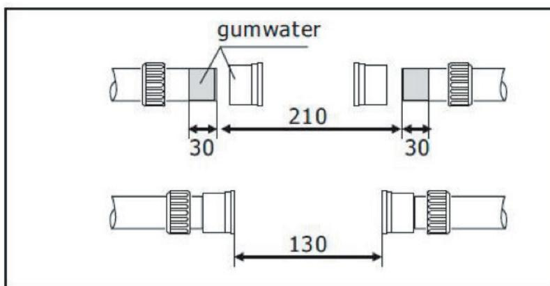
5. Asenna lämmitin (kuva 5). Asenna letku lämmittimen letkuliihtäään. Varmista, että kaikki liitännät ovat täysin tiiviitä. Älä kiristä liittimiä liian tiukalle, sillä muoviosat voivat rikkoutua helposti.
