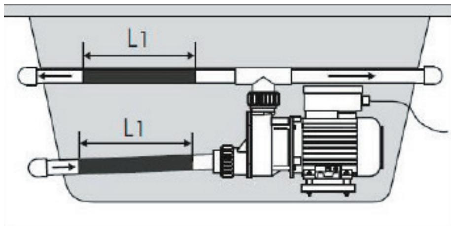
3. PVC slang (fig. 3) Skär till en passande bit PVC slang från pumpens intag eller utlopp och koppla den på värmarens monteringsventil.
