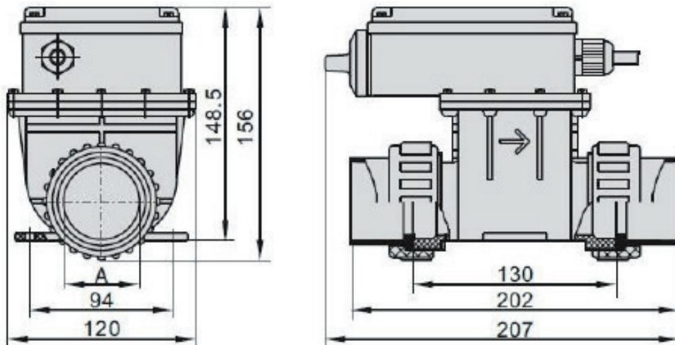
2. Podgrzewacz może być podłączony przez wlot lub ujście pompy układu (rys. 2).
