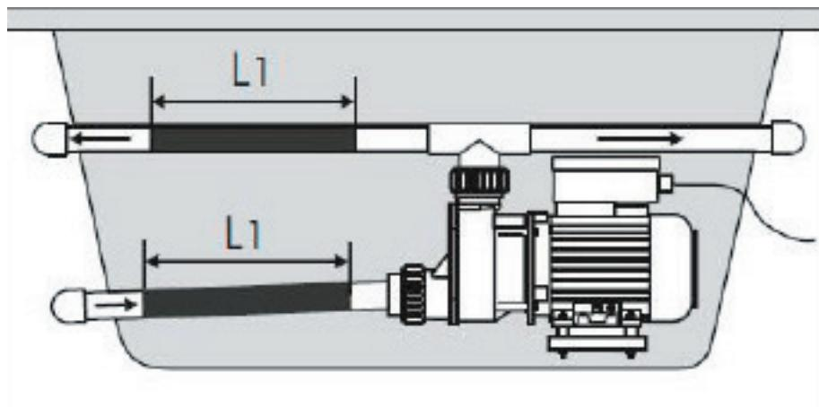
3. PVC-putki: (kuva 3) Katkaise PVC-putkesta/letkusta sopivanmittainen pala pumpun tulo- tai menopuolelta, ja liitä se lämmittimen asennusventtiiliin.
