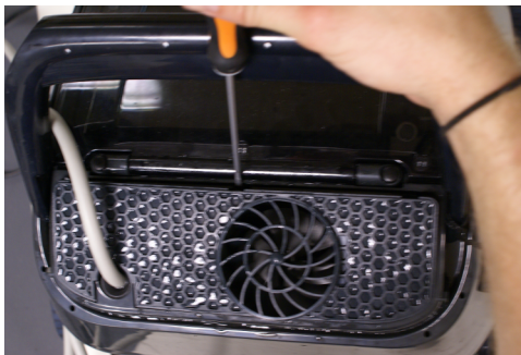
8.1. Brug en flad skruetrækker til at fjerne beskyttelsesgitteret.
