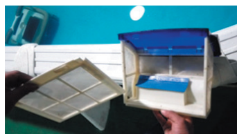
5. Trekk filteret ut vannrett
