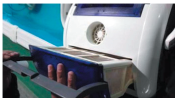
7. Työnnä suodatinkotelo takaisin allasrobottiin uraa pitkin
