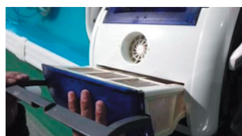
7. Skub filtret bakken tilbage i poolrobotten langs rillen
