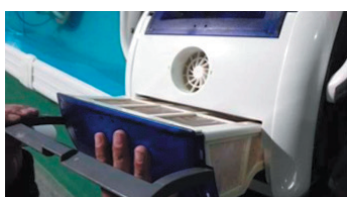
7. Skjut in filterfacket i poolroboten igen längs spåret
