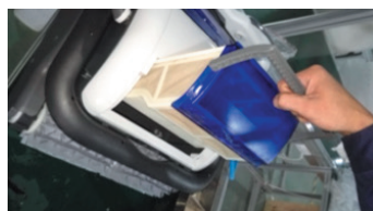
2. Løft ut filterplaten
