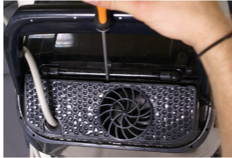
8.1. Käyttäkää tasapääruuvimeisseliä poistaessanne suojaavaa ritilää.
